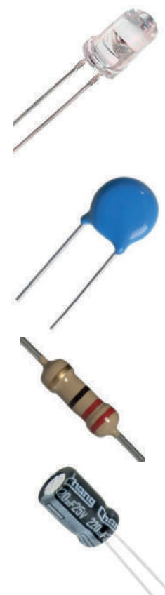
Componentes electrónicos: capacitor electrolítico, condensadores cerámicos, resistencia y diodo led.
