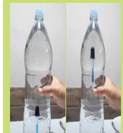
Observe que el gotero empieza a descender hasta llegar al fondo, por la presión ejercida por la mano.
